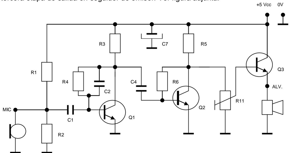
En la figura la configuración en Emisor Común está formada por los transistores Q1 y Q2 es una configuración versátil, ya que las características que presenta permiten una adaptación de la impedancia de entrada y salida desfasando en cada etapa 180° respecto la señal de entrada. Las ganancias tanto de tensión como de intensidad son mayores que la unidad.
