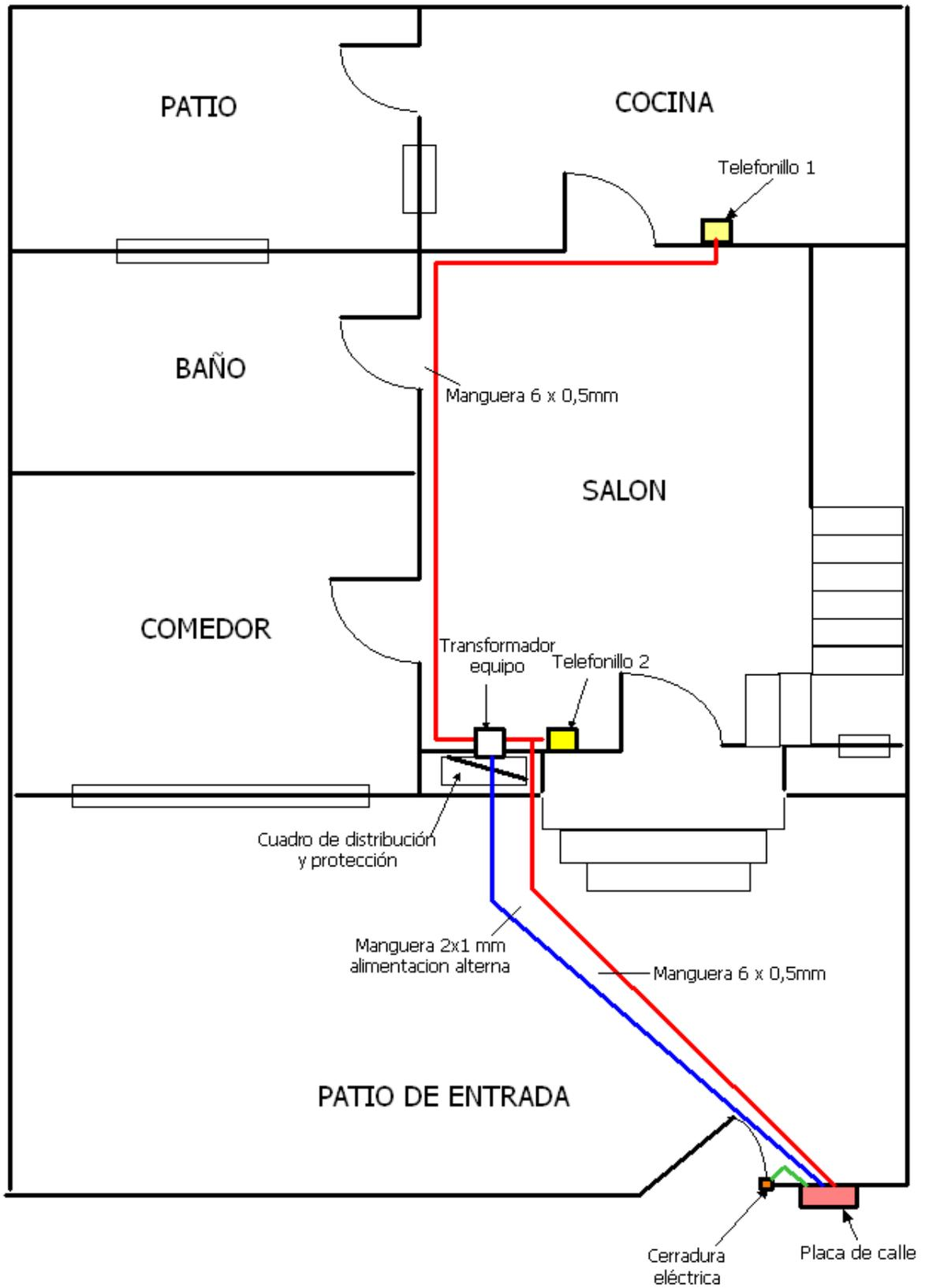
Plano de una vivienda unifamiliar correspondiente a la planta baja. Instalación del portero electrónico.
