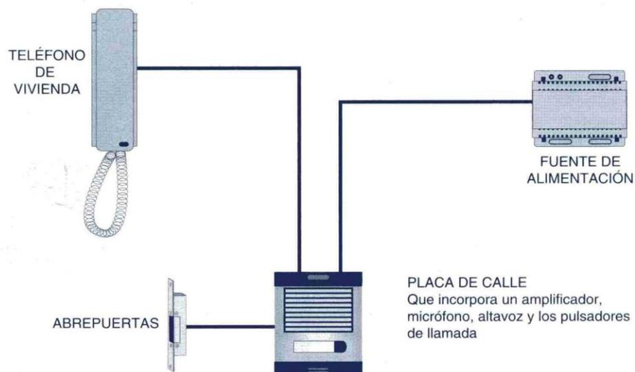
Su funcionamiento es el que sigue: al accionar el pulsador de la placa exterior, se escucha una llamada en el telefonillo. Si éste se descuelga, se establece la comunicación entre el auricular y la placa exterior de calle, permitiendo la conversación en ambos sentidos, pues tanto la placa como el telefonillo disponen de
