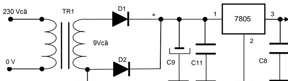
El circuito integrado 7805 regula en positivo y posee la característica de limitar la corriente inversa y protección térmica a la salida.
